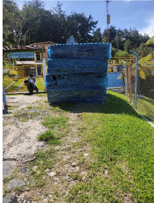
Paneles plásticos tipo colmena
